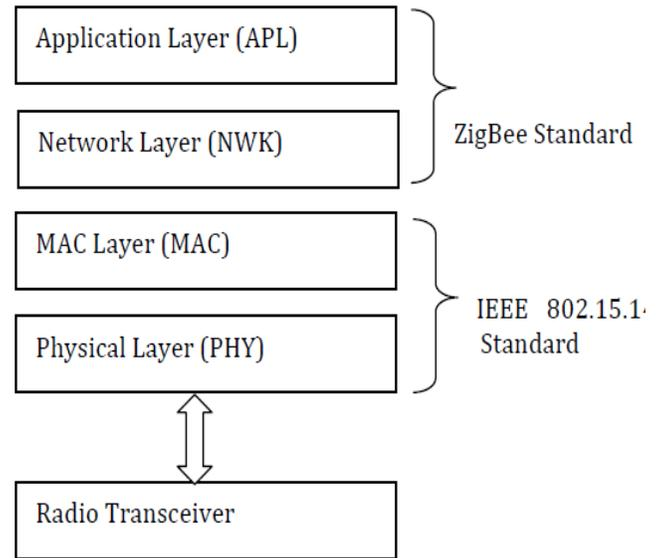
Fig-4.3.2: ZigBee Protocol Stack
